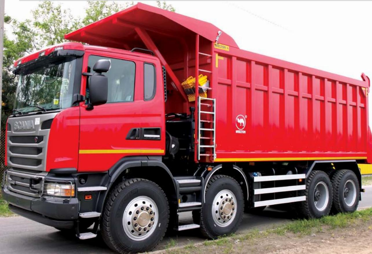
Высокопроизводительный самосвал SCANIA G440 CB8x4EHZ имеет грузоподъемность 32 тонны и предназначен для транспортировки угля и других материалов с плотностью до 1050 кг/м<sup>3</sup> в разрезах, карьерах и по дорогам общего пользования. Загрузка предпочтительна гидравлическими экскаваторами или фронтальными колёсными погрузчиками с объёмом ковша 2 – 5 м<sup>3</sup>.
